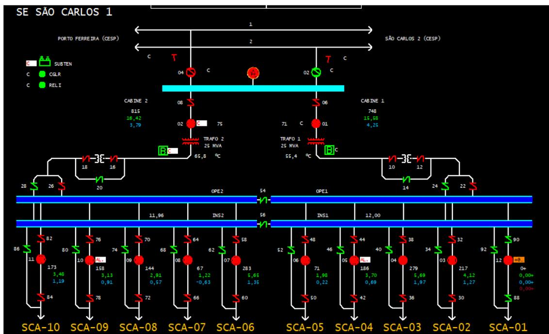
Figura 2 – Diagrama Unifilar da Subestação São Carlos 1
